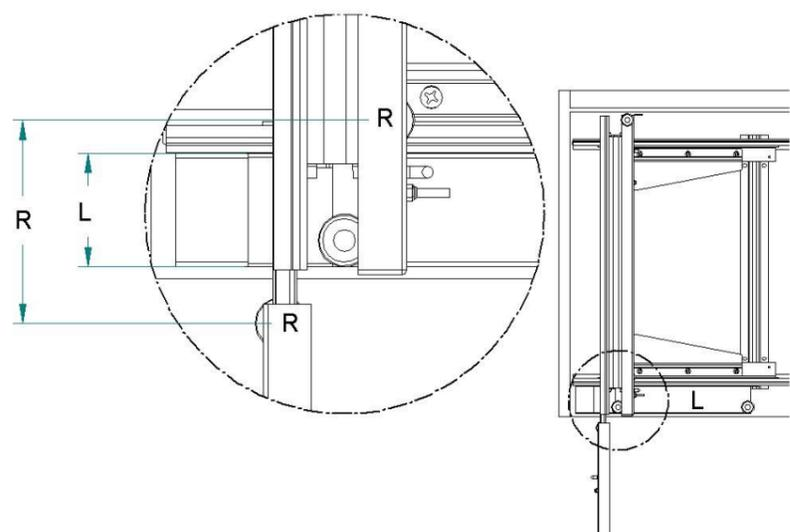
Controllare che le 2 ruote R siano ai lati della lamiera L
