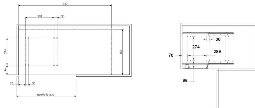
Schema di foratura - Base drilling layout - PF09 120
