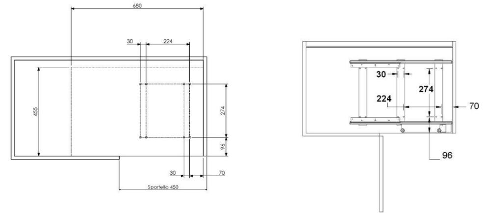
Schema di foratura - Base drilling layout - PF09 120
