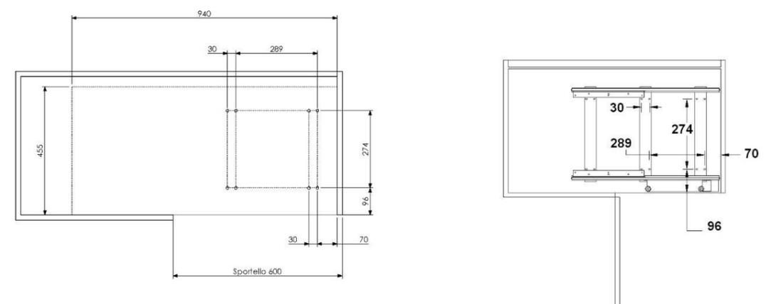
Inserire la guida nel vano e fissare - Put the slide on the base and fixed
